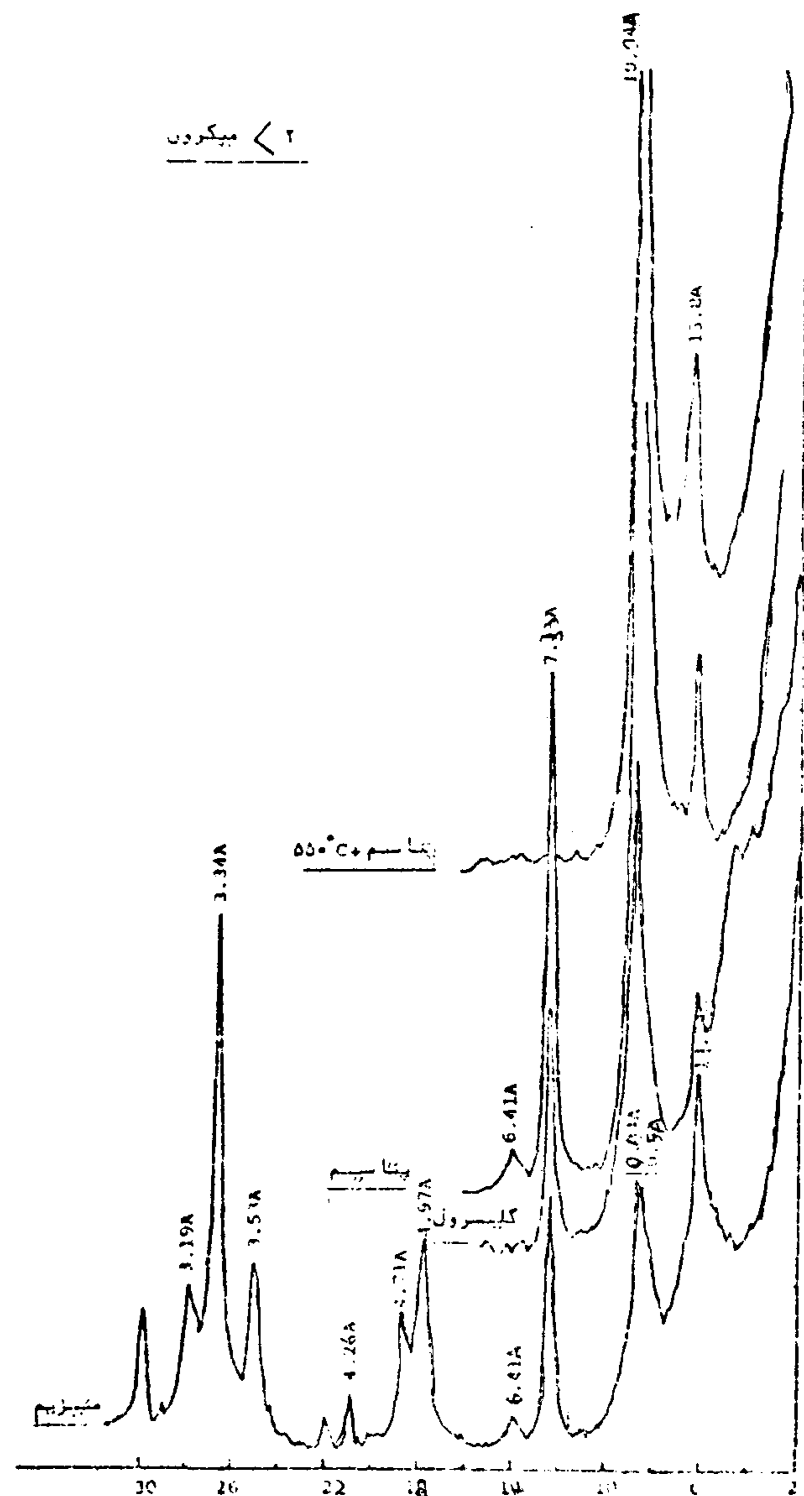
شکل ۶- دیفراکتوگرام اشعه X برای ذرات رس شیرشتر افق A (بالا) و افق B (پایین)
