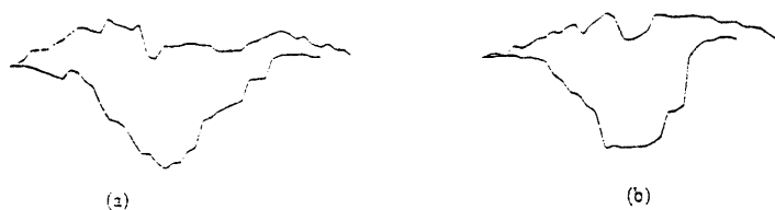
شکل ۵ - نمونه ای از سطح بهم خورده خاک که بوسیله زیر شکن تیغه ارتعاشی در دو حالت (a) بدون ارتعاش و (b) ارتعاشی ، سست و لق شده است .
